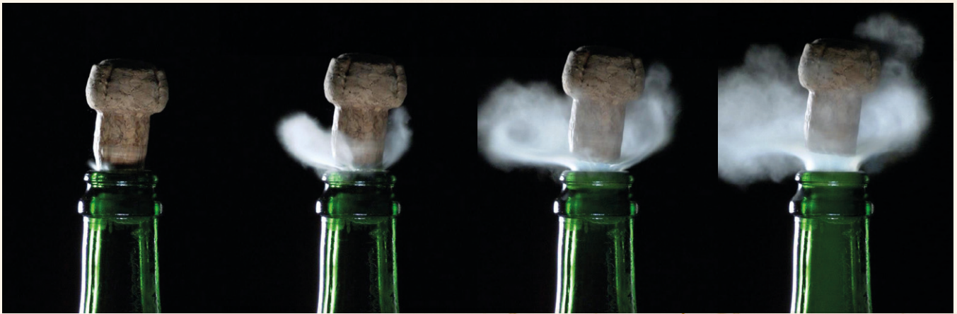
Figure 5. S quence « haute-vitesse » d'un bouchon de Champagne qui saute sous l'effet de la pression qui r gne dans la bouteille (stock e   6  C) ; environ 300 \mu s s parent chaque clich  (Equipe Effervescence).
